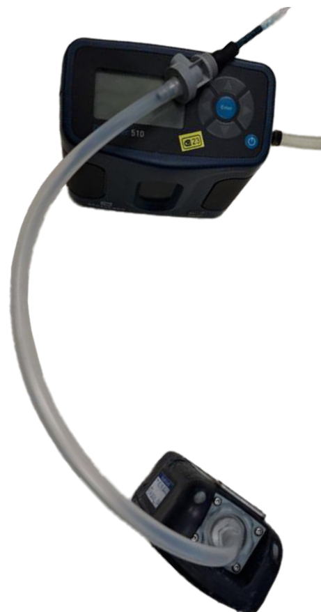
Obrázok 3. Odberové čerpadlo vzorkovacou trubičkou
